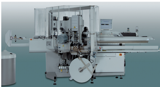
Crimpvollautomat für bis zu sieben Verarbeitungsstationen
