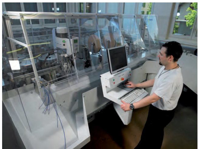
Die Zeta 633 bietet als einzige Maschine die Möglichkeit, 36 unterschiedliche Kabel gleichzeitig zu verarbeiten.
