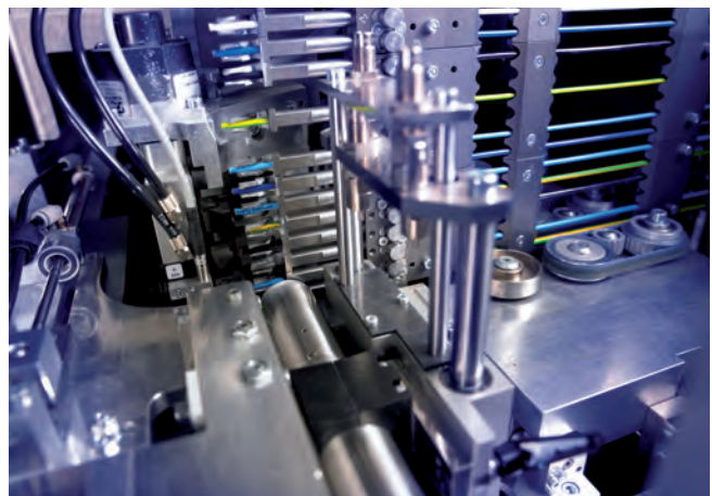
Zwei Drucker mit automatischem Kopfwechsler für weisse und schwarze Beschriftung.
