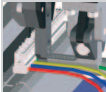
Bestücken der Leitungen – Sicherstellung der Einlegeposition mit Kraft-/Wegmessung
