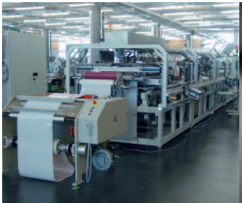
Sibos Anlage für die vollautomatische Verarbeitung von FPC.
